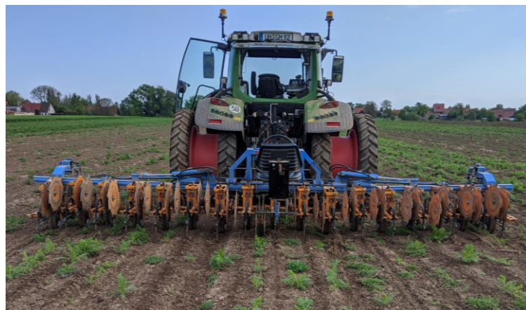
Abbildung 9: Maschinenhacke Schmotzer mit Schutzscheiben und Gänsefußmesser
