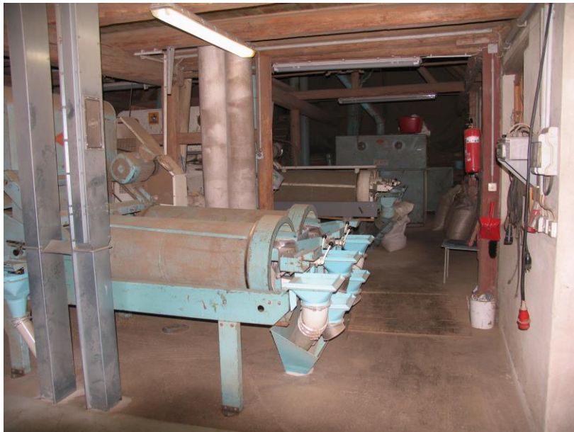
Abbildung 15: Saatgutreinigung mit Petkus K531 ca. 150kg/h
