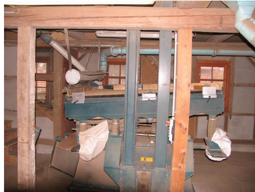
Abbildung 16: Saatgutreinigung mit Tischausleser
