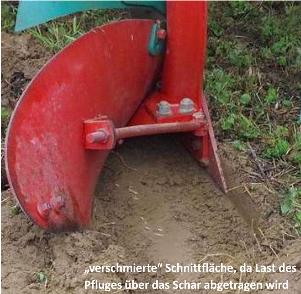
„verschmierte“ Schnittfläche, da Last des Pfluges über das Schar abgetragen wird
